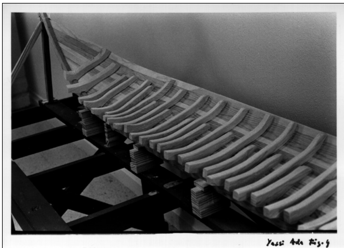
Probabile struttura e tavolatura del ponte dell'imbarcazione
