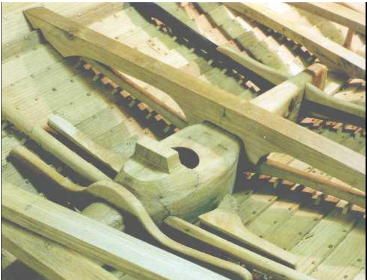
Particolare della struttura interna dello scafo e della scassa
